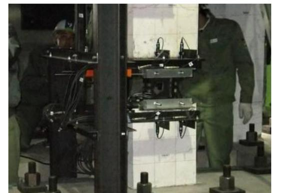
加圧後のフレームと制震装置
