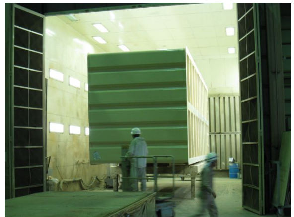
焼き付け塗装中のタンク
