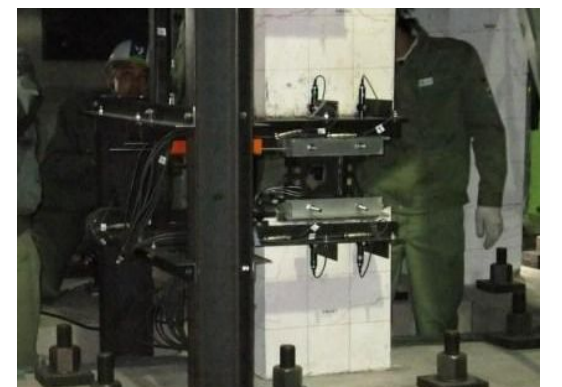
加圧後のフレームと制震装置
