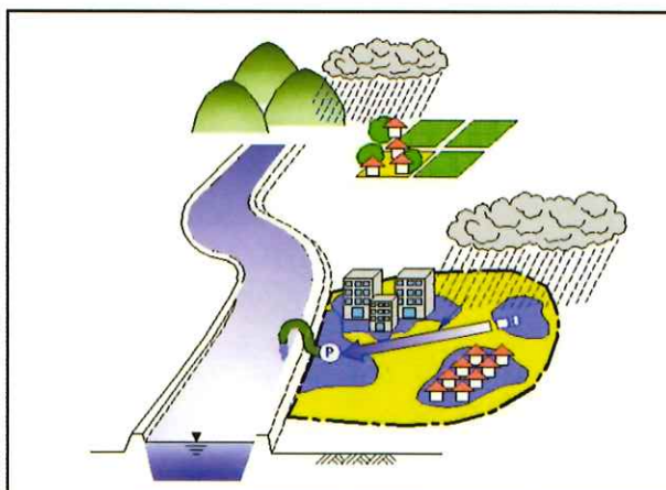
c. 下水道の雨水排水能力を上回る降雨による浸水と、河川へ放流できないことによる浸水
