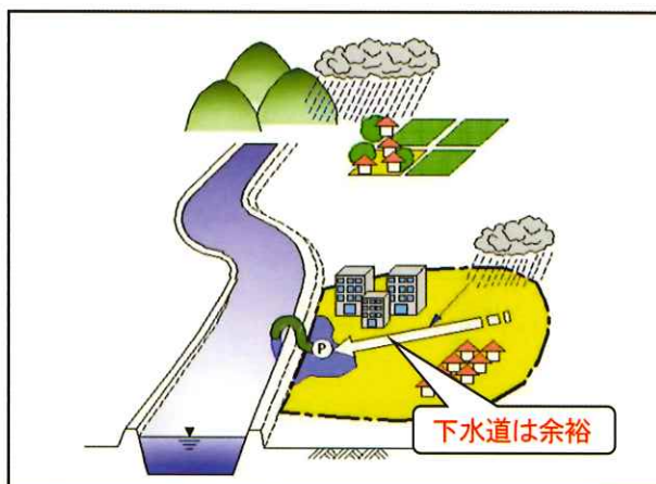
b. 下水道の雨水排水能力以下の降雨であるが、河川へ放流できないことによる浸水
