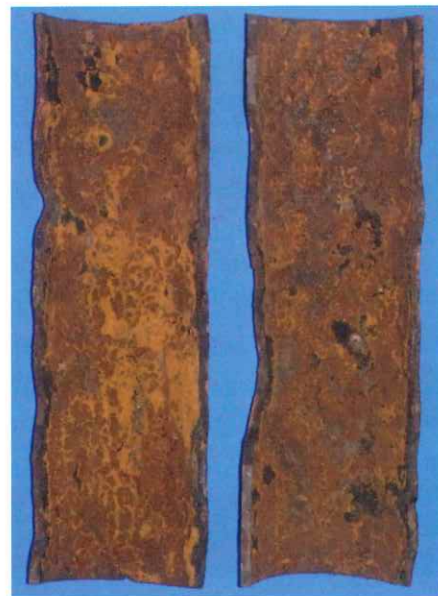
写真11 Phase3 写真10の立て管を持ち帰り、半割りし内部を確認。
