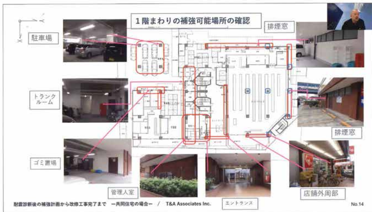
図14 1階まわりの補強可能場所の確認
