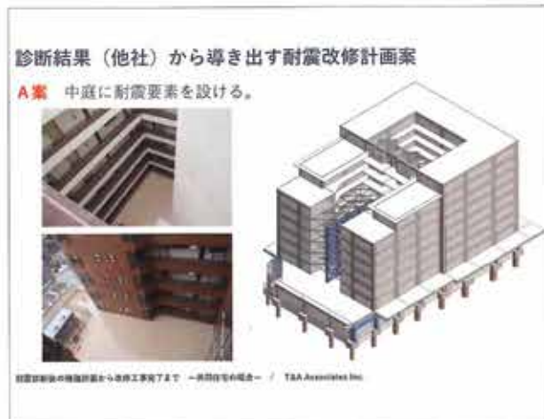
図9 診断結果（他社）から導き出す耐震改修計画案
